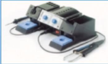
V základnej výbave je rúčka s hrotom 212BD (ostrý s priemerom 0,4mm) a pinzeta s hrotmi 422ED (6mm pre SOIC8). Je možné si doobjednať hroty pre iné súčiastky, napr. MiniMELF, MELF, PLCC, SOIC, QFP. Výkon stanice je 60W.
