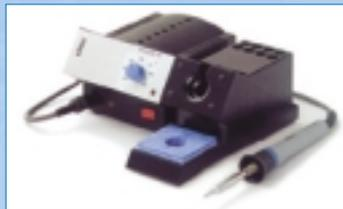
rúčka s hrotom typu 832CD šírky 2,2mm. Na požiadanie je možné zabezpečiť aj iné typy hrotov.
