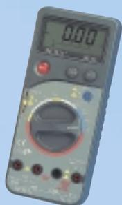
3 3/4 miestny digitálny multimeter s automatickým prepínaním rozsahov a analógovým bargrafom pre sledovanie rýchlych zmien meranej veličiny. Má detekciu polaritu, pretečenia a funkciu RangeHold. K počítaču sa pripája pomocou D-SUB konektora s rozhraním RS232C. Umožňuje merať aj kapacitu do 400mF, teplotu do +1200°C a hFE tranzistorov.
