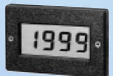
Modul 3,5- miestneho LCD voltmetra merajúceho napätia do 199 mV s presnosťou 0,5%. **Technické údaje:** vstupný odpor 100M $\Omega$  a citlivosť 100 $\mu\text{V}$ , napájanie modulu 9 až 12V, prúdový odber je 1mA, výška číslic 13mm a vonkajšie rozmery  $68 \times 44 \times 15\text{mm}$ .
