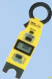
Kliešťový AC ampérmeter do 320A. Prístroj s dvomi kliešťami, na jednej strane s klasickými, na druhej s novými patentovanými, ktoré nie je potrebné uzatvárať. Ideálny pre použitie v priemysle, pri opravách vetraní, vyhrievacích telies alebo klimatizácií. Malé rozmery umožňujú jeho použitie aj v stiesnených podmienkach. Na zobrazenie slúži LCD displej s bargrafom.
