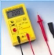
Prístroj na meranie izolačného odporu elektrických zariadení a vedení. Má dva meracie rozsahy (200 MΩ, 2000 MΩ) a chybu merania max. 3%. Okrem izolačného odporu meria aj striedavé napätia do 750 V a malé odpory do 200. Výsledky merania sa zobrazujú pomocou 3,5-miestneho LCD displeja. Prístroj má zabudovanú ochranu proti preťaženiu a funkciu Data Hold na zapamätanie údajov. Jeho rozmery sú 100 x 65 x 165 mm a hmotnosť 860 g.
