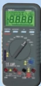
Digitálny multimeter s 3 3/4 miestnym LCD displejom, ktorý zobrazuje dve veličiny v jednom čase a obsahuje aj analógový bargraf. Prístroj je vybavený automatickým prepínaním rozsahov a vypínaním, ako aj funkciami DataHold, RangeHold, Auto/Min/max pamäťou a pamäťou na 10 nameraných hodnôt. Neumožňuje prepojenie s počítačom.
