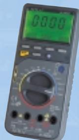
Digitálny multimeter merajúci skutočnú efektívnu hodnotu (TrueRMS) s 3 3/4 miestnym LCD displejom, ktorý zobrazuje až 4 veličiny v jednom čase a obsahuje aj analógový bargraf. Prístroj je vybavený automatickým prepínaním rozsahov a vypínaním, funkciami DataHold, min/max pamäťou, porovnávaním hodnôt. Pomocou rozhrania RS232C je pripojiteľný k počítaču. Zaujímavou funkciou je meranie výkonu do 4000W pomocou adaptéra (nie je v príslušenstve) a vnútorný generátor priebehov.
