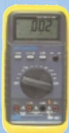
Digitálny multimeter s automatickým prepínaním rozsahov a 3 3/4 miestnym LCD displejom a bargrafom. Umožňuje merať AC/DC napätia, AC/DC prúdy, odpor, frekvenciu do 150kHz, kapacitu do 32,6μF. Testuje diódy, tranzistory, skrat. Príslušenstvo: meracie šnúry, držiak, batéria, manuál.
