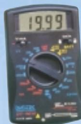
Digitálny multimeter s manuálnym prepínaním rozsahov a 3 1/2 miestnym LCD displejom. Prístroj meria AC/CD napätia do 600V, AC/DC prúdy do 200mA, odpor do 20MΩ. Ďalej obsahuje tester diód a skratu (akusticky-bzučiak), tester 1,5V a 9V batérií a funkciu DataHold. Napájanie prístroja je 12V alkalickou batériou.
