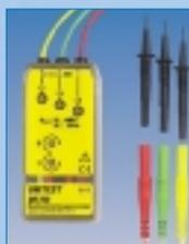
Indikátor sledu fáz (doľava, doprava), ktorý indikuje aj prítomnosť napätí na jednotlivých fázových vodičoch. Výsledky merania sa zobrazujú pomocou piatich tlejiviek. Prístroj je vhodný na meranie striedavých napätí v rozsahu 80-600 V s frekvenciou 50-60 Hz. Jeho rozmery sú 100 x 50 x 25 mm a hmotnosť 170 g.
