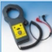
Kliešťový adaptér k multimetru. Meria jednosmerné a striedavé prúdy (50-60Hz) až do 2000A. Je pripojiteľný k ľubovoľnému voltmetru, pričom 1mV na displeji zodpovedá 1A meraného prúdu. Veľkosť roztvorenia klieští je 50mm.
