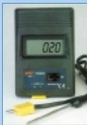
Digitálny teplomer s LCD displejom a senzorom TP-01. Jeho merací rozsah  $-50^{\circ}\text{C}$  až  $+250^{\circ}\text{C}$  (s TP-01), pričom samotný prístroj umožňuje zobraziť teploty až  $-50^{\circ}\text{C}$  až  $+1200^{\circ}\text{C}$  (so senzorom typu K - nie je v príslušenstve). Presnosť prístroja je  $1^{\circ}\text{C}$ , rozmery  $70 \times 105 \times 20\text{mm}$ , hmotnosť 150g.
