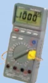
Digitálny multimeter s 3 1/2 miestnym LCD displejom, ktorý zobrazuje dve veličiny v jednom čase a obsahuje aj analógový bargraf. Prepínanie rozsahov a vypínanie je manuálne, je vybavený funkciami DataHold, Min/max pamäťou a porovnávaním nameraných hodnôt. Umožňuje komunikáciu s počítačom pomocou rozhrania RS232C.
