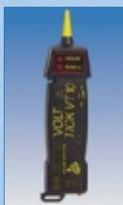
Bezdotyková skúšačka striedavého napätia. Ideálna na hľadanie prerušených vodičov v stenách. Nastaviteľná citlivosť prístroja, detekcia napätia už zo vzdialenosti 10cm, akustická a optická (pomocou LED), signalizácia prítomnosti napätia, napájanie pomocou 9V batérie
