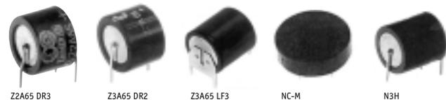
Rozmery: Akumulátory Z2A majú priemer 15,5mm a dĺžku 12mm. Akumulátory Z3A priemer=15,5mm a dĺžka=17,4mm, akumulátory NC-M priemer=23,5mm a výška 8,6mm, 13,3mm resp. 16,5mm pre NC-M 2,4, NC-M 3,6 resp. NC-M 4,8. Akumulátor N3H je NiMH s priemerom 17mm a dĺžkou 17,4mm.
